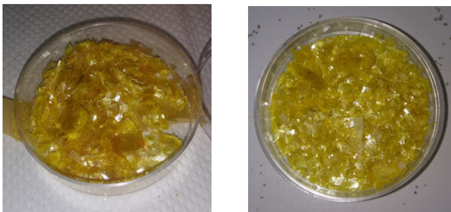
Rysunek 2.19: Wstążki materiału otrzymane techniką twin-rollers . Zdjęcia własne.
