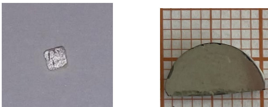
Rysunek 3.8: Przykładowe próbki przygotowane do pomiarów metodą spektroskopii impedancyjnej przez wycięcie fragmentów pastylek z naniesionymi elektrodami platynowymi.
